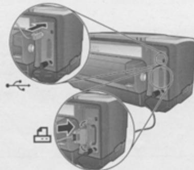
إذا كنت تستخدم وصلة USB (محول) أو وصلة متوازية (Parallel)، صل الكابل (الذي يمكّن منفصل) عند الحاجة أثناء التثبيت. (التوصل إلى التوازي قم بإزالة غطاء النقب أولاً). ثم قم فقط بتنبّه الكابل المتوازي أو كابل USB وليس كلاهما.
